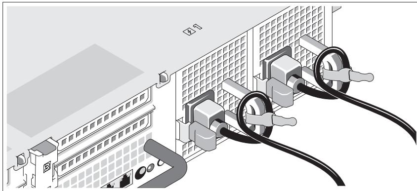
Dobre o cabo de alimentação do sistema formando um laço, conforme mostrado na figura, e prenda-o com a tira fornecida.
